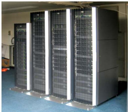
Fig.24 Opteron 2.8GHz 64CPU および Infiniband 高速通信機構で構成されるクラスター並列計算機
